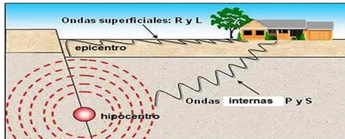
Figura 26. Esquema de la propagación de las ondas sísmicas
